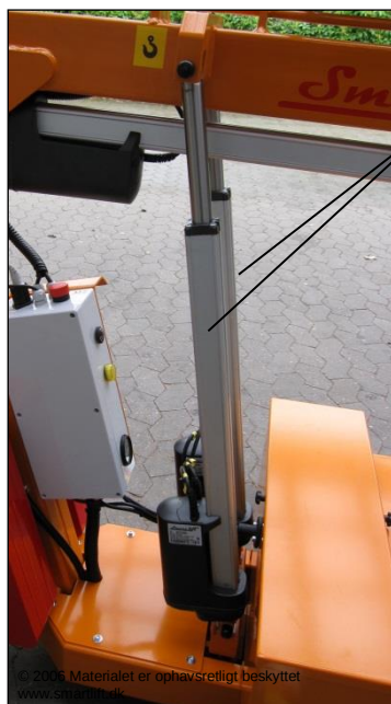
Aktuatorer for løft 2 stk. Linak LA 36
